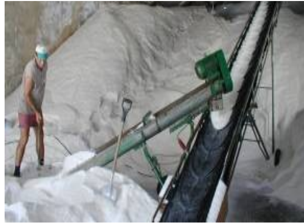
Figura 32 - Elevar o sal com o auxílio do senfim e da fita transportadora
