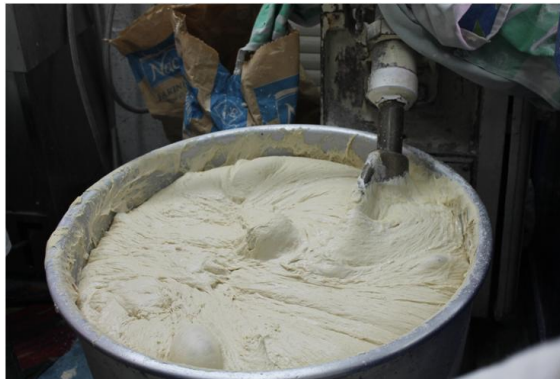
Figura 2. Processo de amassadura mecânico - recurso a uma bateadeira elétrica
