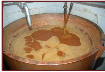
Fig. AIII.14 –Tacha de Evaporação do “caldo de cana” para obtenção do xarope
