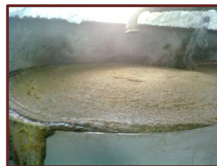
Fig. AIII.8 – Clarificação - pré-cozedura da guarapa para eliminação de substâncias corantes e impurezas.
