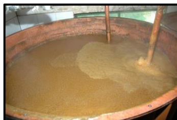
Fig. AIII.11 – Evaporação - concentração da guarapa e caramelização dos açúcares
