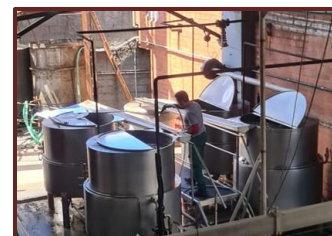
Fig. AIII.12– Evaporadores ou Tanques de concentração do "caldo de cana"
