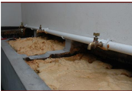
Fig. 16 – Concentração nos Evaporadores
