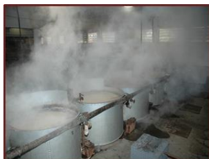
Fig. AIII.10 – Evaporação de concentração da guarapa e caramelização dos açúcares.
