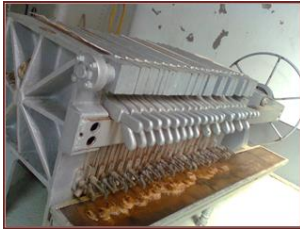
Fig. AIII.13 – Filtração do “xarope” resultante da concentração por evaporação da guarapa
