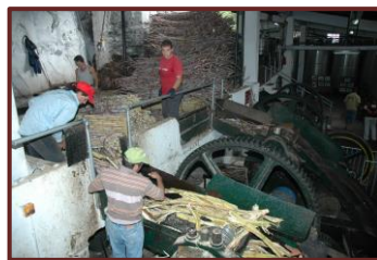
Fig. AIII.5– Armazenamento e corte da cana sacarina para iniciar a sua transformação
