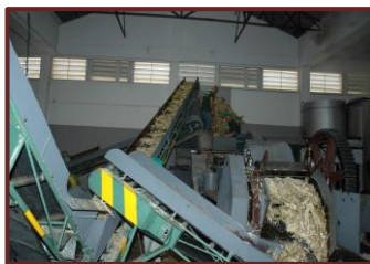
Fig. AIII.4 – Moenda dos colmos e bagaço de cana para a extração da guarapa
