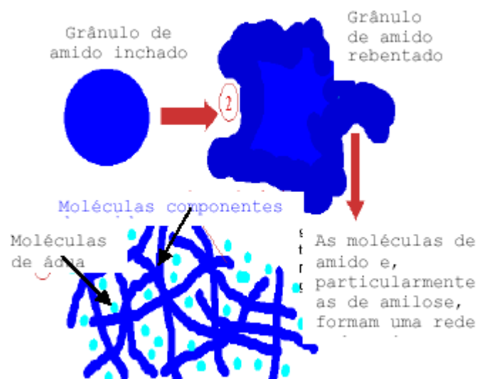
fig. 6- Grânulos de amido e o seu comportamento no contacto com a água
